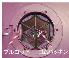
キャップを開けカムを回し、プルロッドの先端を中央部の位置にして下さい。
