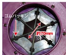
プルロッドに付いているゴムパッキンを全て写真と同じ位置までスライドさせて下さい。これで、インサートパッキンの取付け完了になります。
