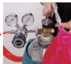
バルーンが折り曲がらないようにガスを注入します。
