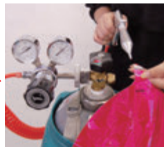
トリガーを引きガスを注入します。
